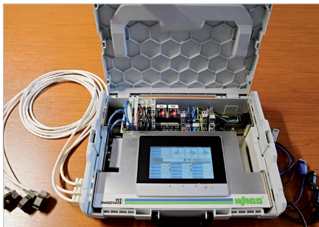
Ukážka realizácie systému OPTIBOX v prenosnom kufri. HMI komunikácia cez zabudovaný webový panel a pripojením do siete ethernet. Ukladanie dát do zabudovanej SD karty.
